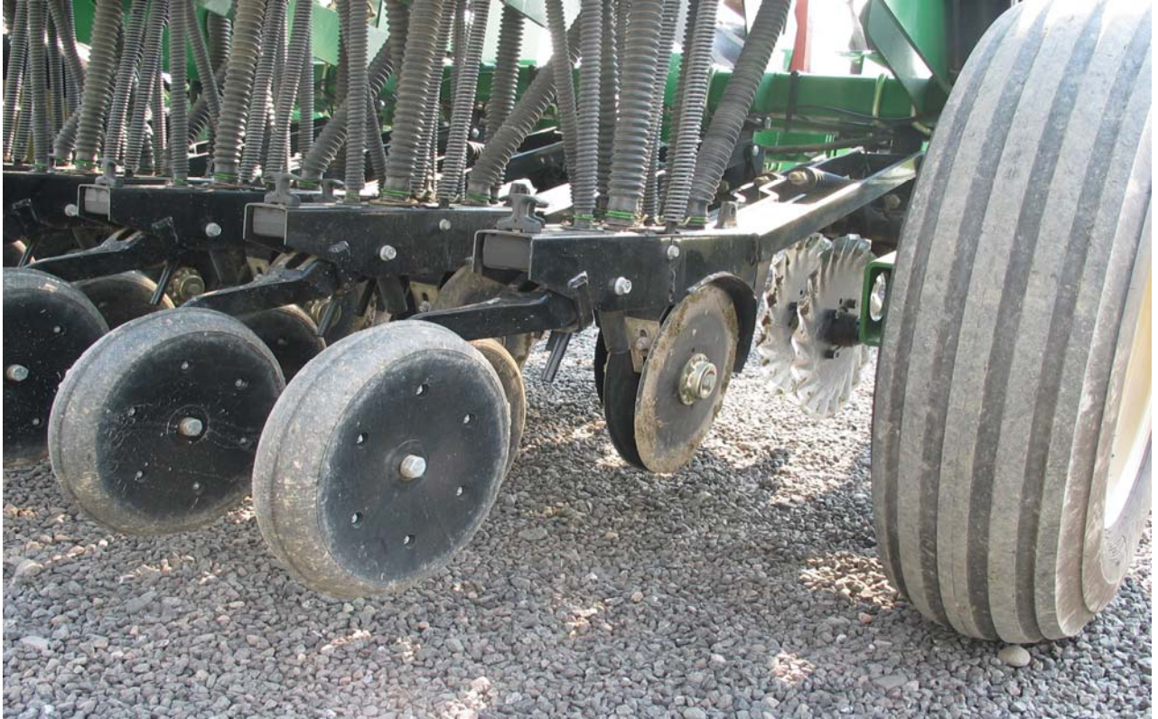
Détail d'un semoir Great Plains de 6' (1,9 m) de large : les coutres ondulés « turbo », précèdent et sont portés sur la même structure que les unités de semis.
